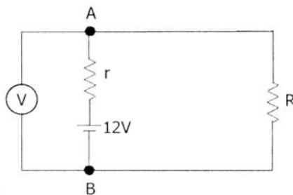
Indique qual dos gráficos abaixo melhor representa a leitura (V) do voltímetro, como função do valor (R) da resistência externa.
